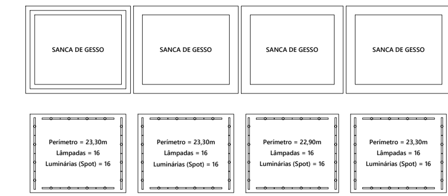
DETALHE SANCA DE GESSO E ILUMINAÇÃO ESCALA 1/250
